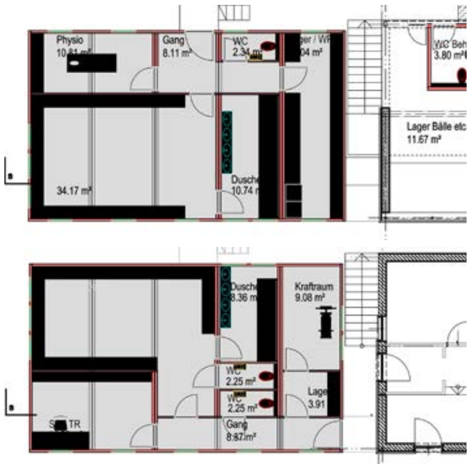
Das bestehende Gebäude der Sportanlage Hoferfeld wird in Containerbauweise um Umkleideräume und Nebenräume erweitert.
