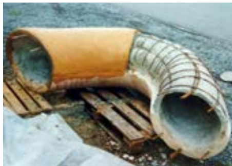
Der Aufbau der Seeschlange: Ein aufwändig konstruierter Hohlkörper aus Stahl und Beton
